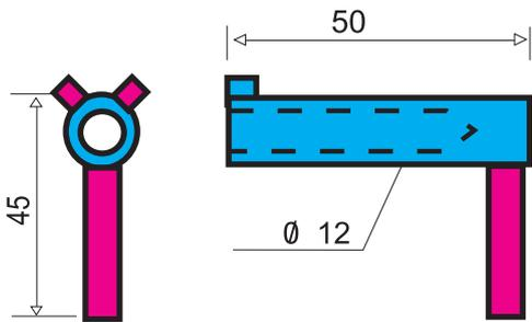
Steckbolzen für die Verriegelung, verzinkt
