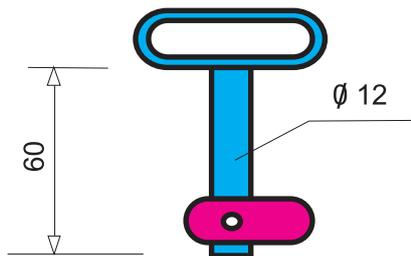
kleiner Steckbolzen für Stützen, verzinkt
